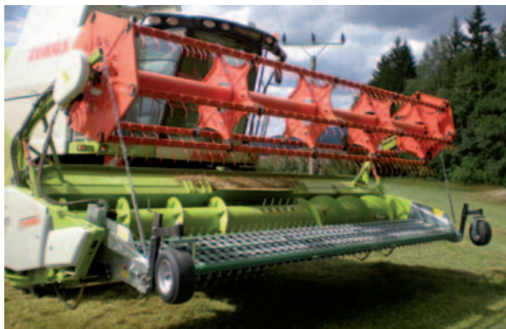
Obr. 33 – Sběrací adaptér DEN DEKKER DZ 5,8 je možné připevnit přímo na lištu kombajnu.
