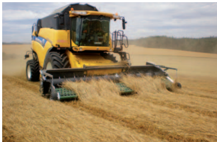
Obr. 34 – Sběrací komplet sestavený z lišty Tecnomais a adaptéru DEN DEKKER DZ 5,8 je vhodný pro veškeré širokozáběrové sklízecí mlátičky.
