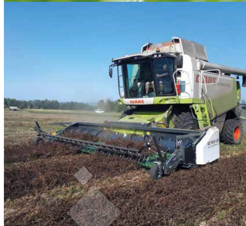
Dvoufázová sklizeň jetele lučního Sběrací komplet Dekker Tecnomais 5,8 m s přídržovací konzolou
