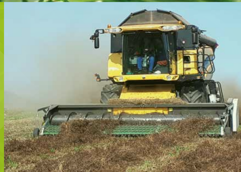
Dvoufázová sklizeň jetele lučního Sběrací komplet Dekker Tecnomais 5,8 m
