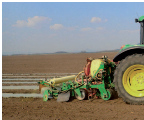
Obr. 14 – Setí kukuřice pod degradovatelnou fólií strojem Samco.
