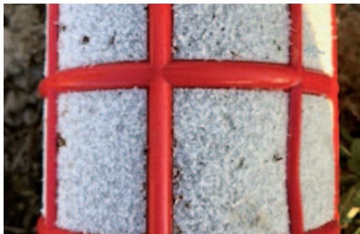
Obr. 25 – Zanesení aplikační techniky lze předejít použitím pHAD pro snížení tvrdosti vody.
