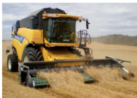
Obr. 28 – Sběrací komplet sestavený z lišty Tecnomais a adaptéru DEN DEKKER DZ 5,8 je vhodný pro veškeré širokozáběrové sklízecí mlátičky.
