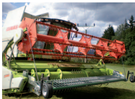
Obr. 27 – Sběrací adaptér DEN DEKKER DZ 5,8 je možné připevnit přímo na lištu kombajnu.
