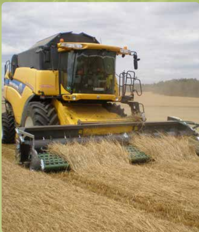
Dvoufázová sklizeň jílku jednoletého sběracím kompletem Dekker Tecnomais 5,8 m
