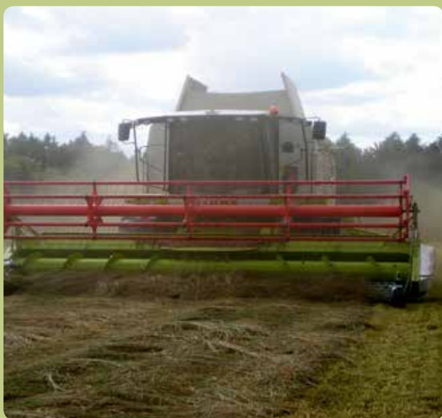
Dvoufázová sklizeň mezirodového hybridu Mahulena vestavným adapterem Dekker DZ 5,8 m
